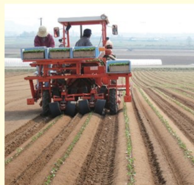
STP-2MSTによる移植作業
