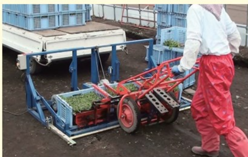
苗箱に苗をセットしフットスイッチを踏むと苗箱がリフトアップします。
