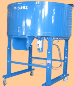
①培土混合機 FRM-5 堆肥や肥料と培土の混合
