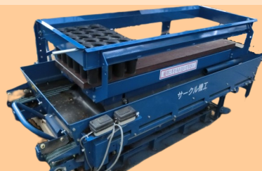
②培土充填機 FRF-C ポットや苗木コンテナへの土入れ
