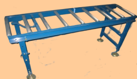
③排出ローラ FRR 培土充填機から苗の移動
