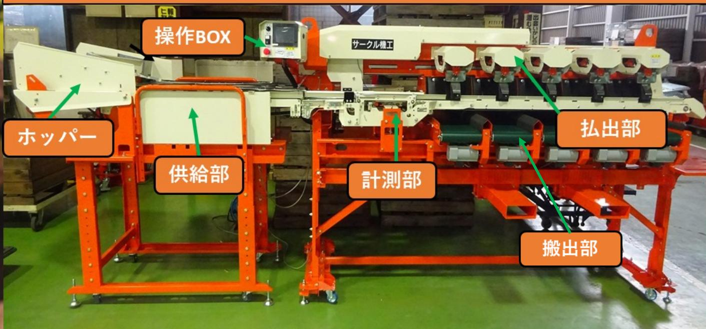
ホッパーに投入した人参を供給部で1列に整列させつつ、1本ずつ計測部に流すことで重量を計測します。
